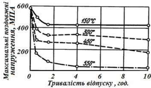
Рисунок 2.3.1 – Вплив температури та часу витримки на рівень залишкових напружень
