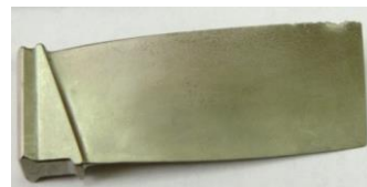
Рис. 1. Лопатка I-го ступеня дв. ТВ3-117 із пошкодженнями пера
