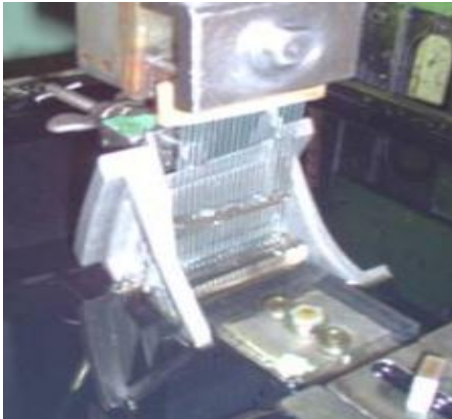
Рисунок 1.5 – Багатоелектродного обробка декількох отворів в лопатці з жароміцного сплаву
