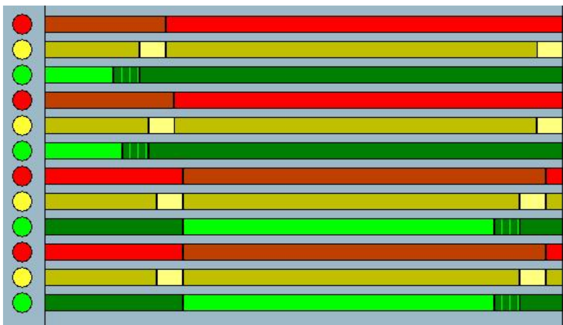
Рисунок 2.20 - Циклограма роботи світлофорного об'єкту на перехресті пр. Моторобудівників – вул. Чарівна (двофазний цикл)
