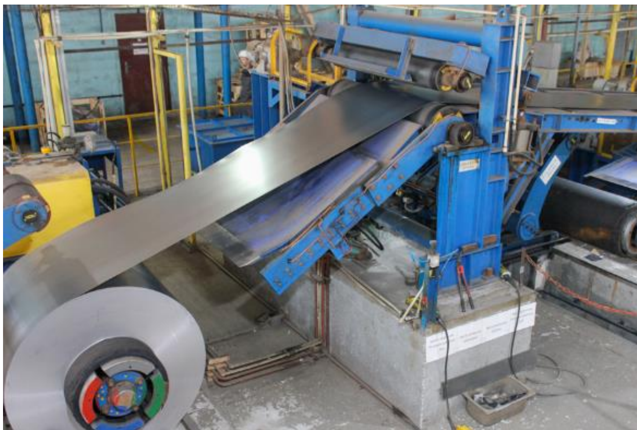
Рисунок 1.1 – Технологічний процес цинкування сталі у рулонах на ТОВ «Юністіл»
