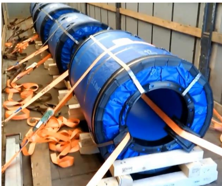
Рисунок 1.6 – Пакування для захисту рулонів металопродукату від атмосферних впливів
