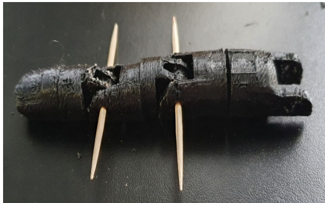
Рисунок 3.8 – Фаланги пальців Інтерактивного маніпулятора роздруковані на 3D-принтері
