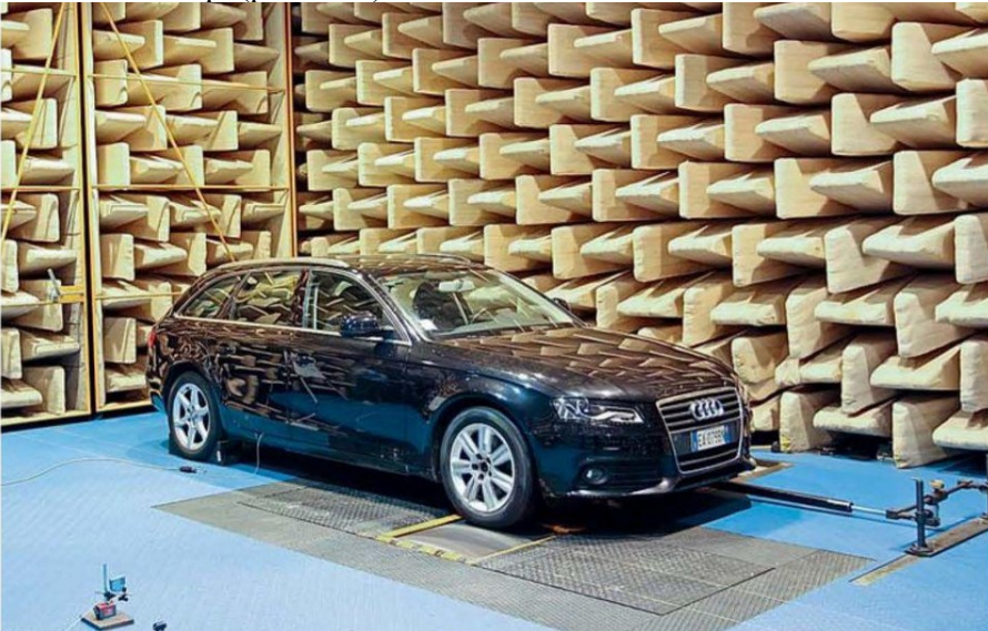
Рисунок 9.16 – Безехова камера для визначення рівню шуму від шин
