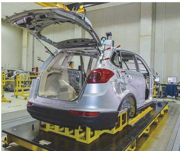
Рисунок 9.11 – Перевірка геометрії кузова на вимірювальному стенді
