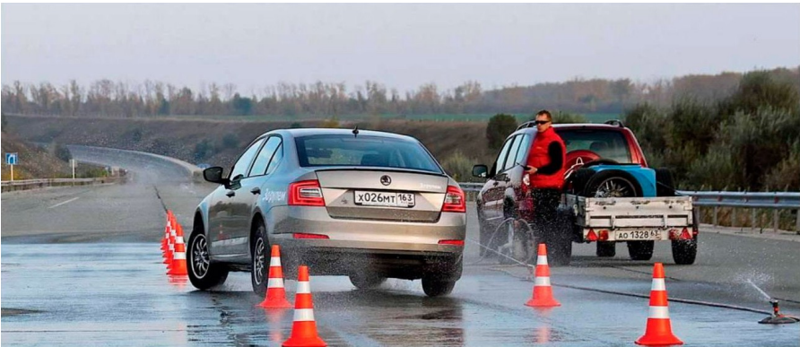
Рисунок 9.24 – Випробування автомобіля на керуваність на мокрому асфальті (поперечне аквапланування)
