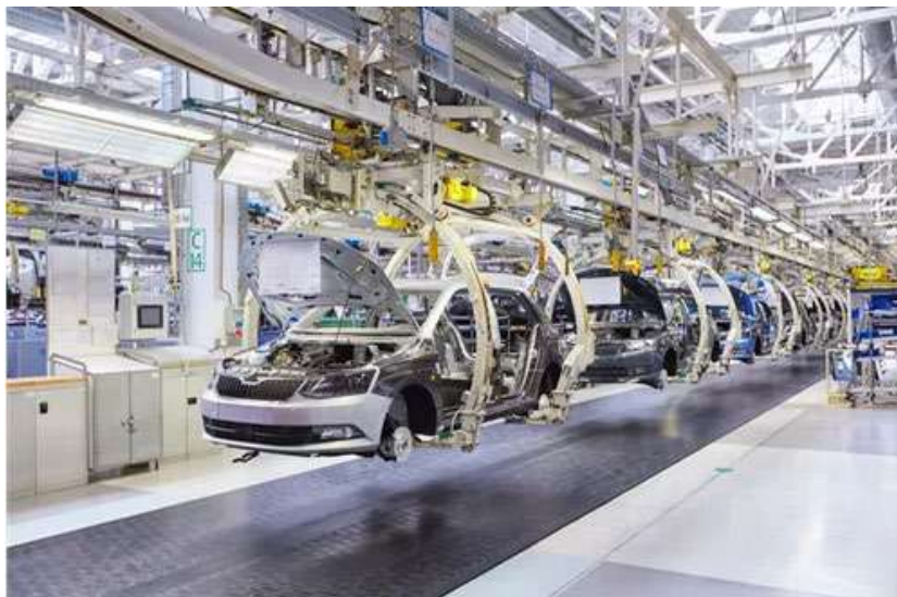
Рисунок 1.4 – Конвеєрна складальна лінія виробництва автомобілів
