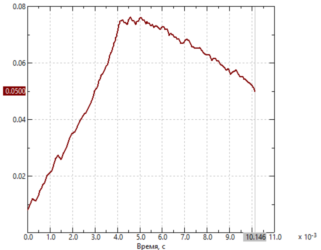
Рисунок 4.21 - Графік залежності зусилля деформації від часу, комбінація Магній-М1
