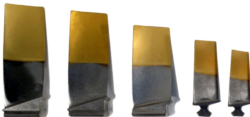
Рисунок 2.1 Лопатки компресора після процесу КІБ.
