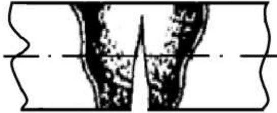
Рисунок 2.6 – Характер нагріву нерівно обрізаних заготовок при зварюванні опором
