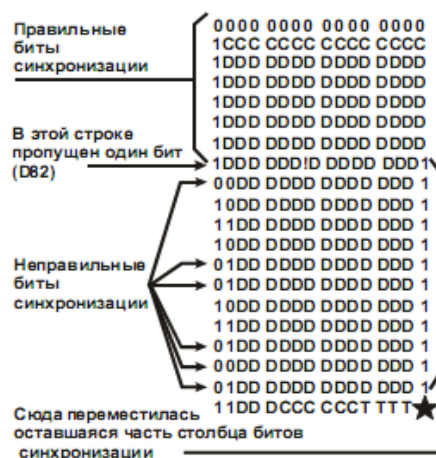
Рисунок 3.4 – Ще один приклад кадру з помилкою, викликаною прослизанням
