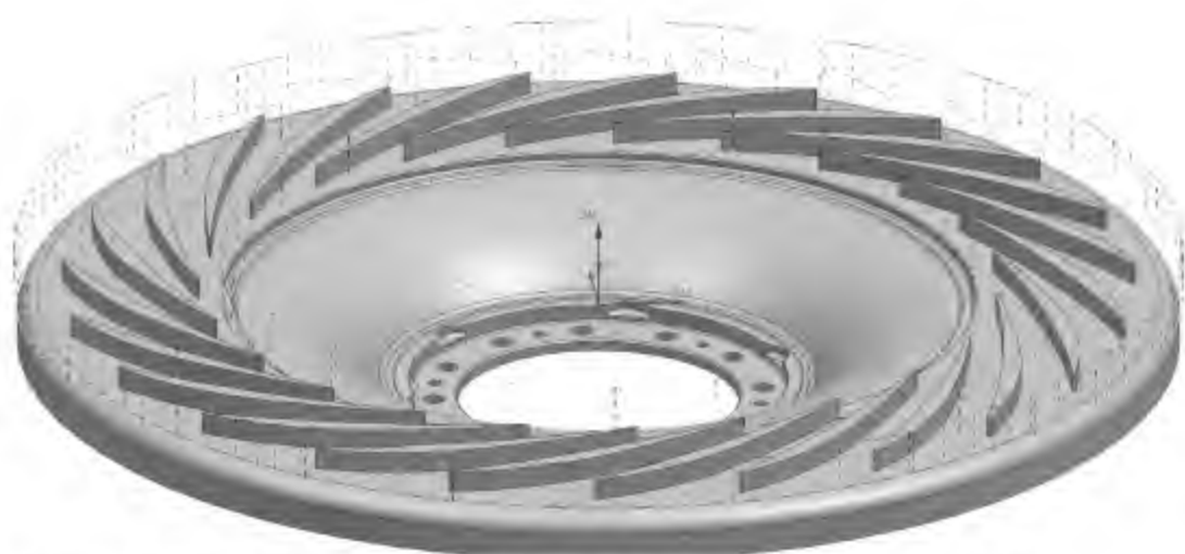
Рисунок 1.22 – Трасекторія руху фрези на чорновому переході
