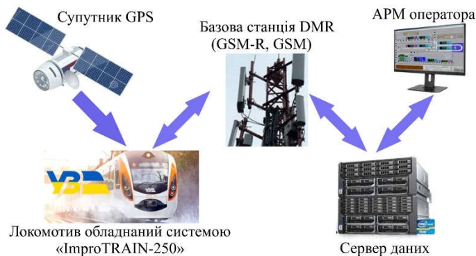
Рисунок 2 – Цифровий радіозв'язок в системі локомотивної безпеки «ImproTRAIN-250»
