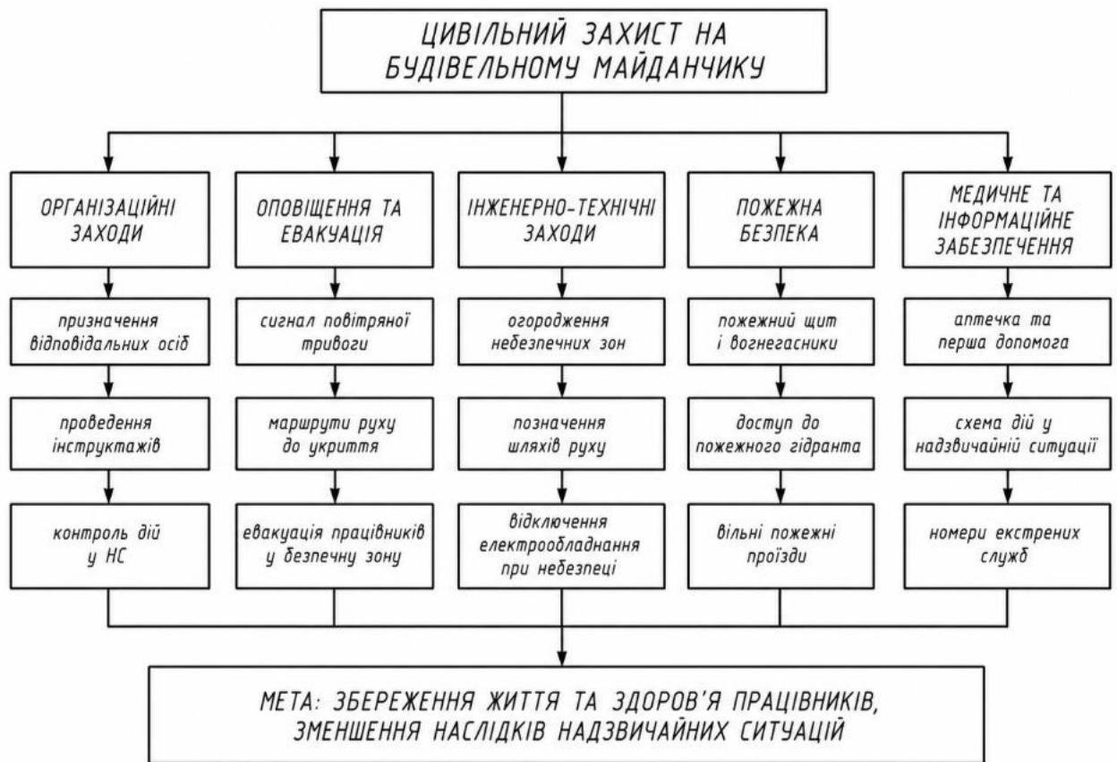
Рисунок 5.4 – Заходи цивільного захисту на будмайданчику
