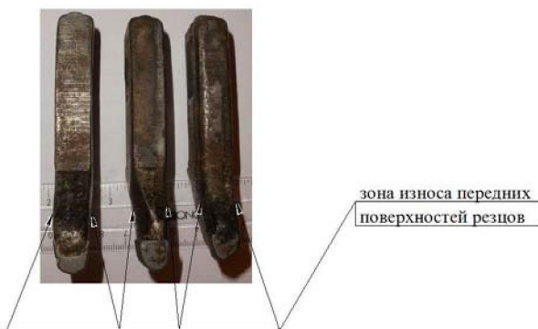
Рис. 5. Характер износа передней грани резцов
