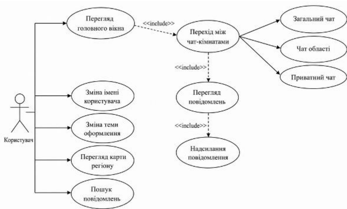
Рисунок 3.4 – Діаграма взаємодії користувача з інтерфейсом вебзастосунку
