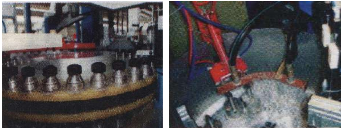
Рис. 4.8. Автоматичний комплекс для гарту болтів гусениці. Автоматичний комплекс для гарту головок протиугінних болтів кріплення автомобільного колеса
