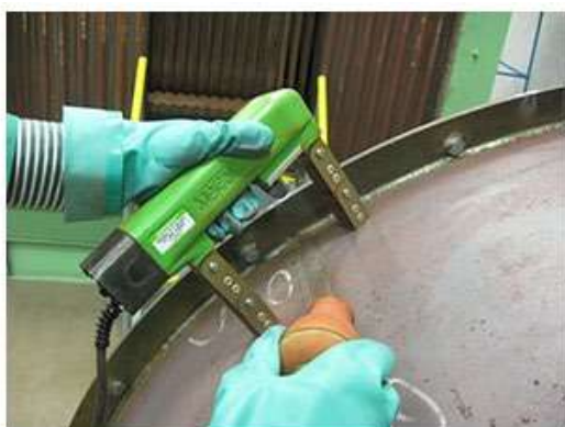
МТ дослідження поздовжнього шва на діючому котлі.
