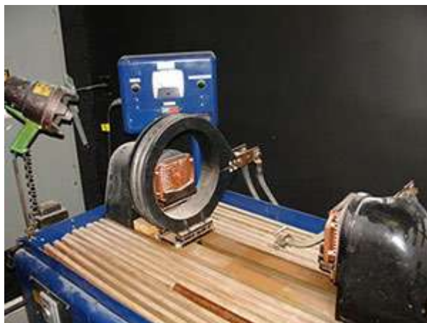
Рисунок 4.3 - Стаціонарна система дослідження магнітних частинок, створена для поздовжньої та кругової намагніченості за допомогою вологих флуоресцентних частинок [7].
