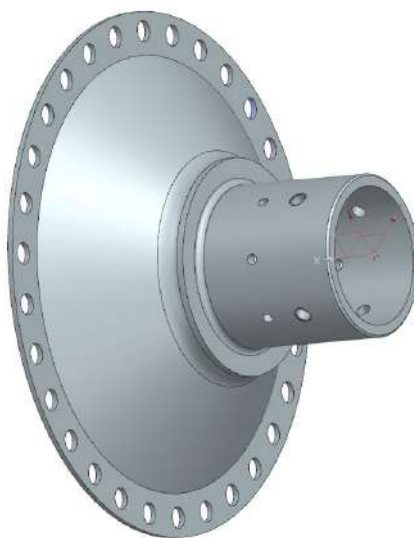
Рисунок 1.12 – Операційний ескіз на фрезерну операцію з ЧПК у тривимірному просторі
