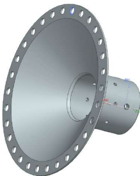
Рисунок 5.1 – Віртуальна модель заданої деталі для розрахунку на міцність
