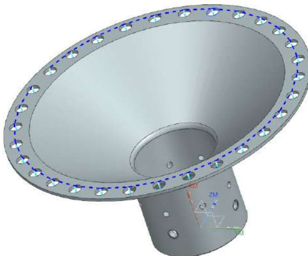
Рисунок 1.18 – Траєкторія обробки на задану операцію
