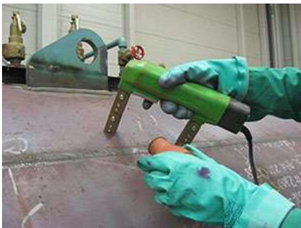
Рисунок 4.4 - Зовнішній поздовжній шов робочого котла перевіряється методом магнітно-порошкового дослідження за допомогою ярма змінного струму з сухим порошком [7].
