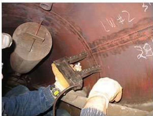
Використання ярма змінного струму в процесі МТ для виявлення втомних розривів у зварних швах парового барабана під час оцінювання в процесі експлуатації.
