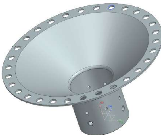
Рисунок 1.16 – Операційний ескіз на фрезерну операцію з ЧПК у тривимірному просторі
