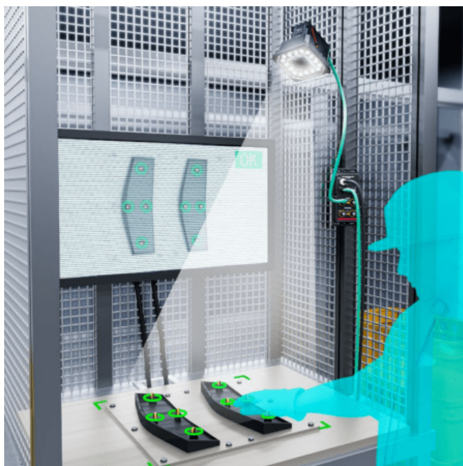
Рисунок 3.7 – Процес використання камери VS [6]
