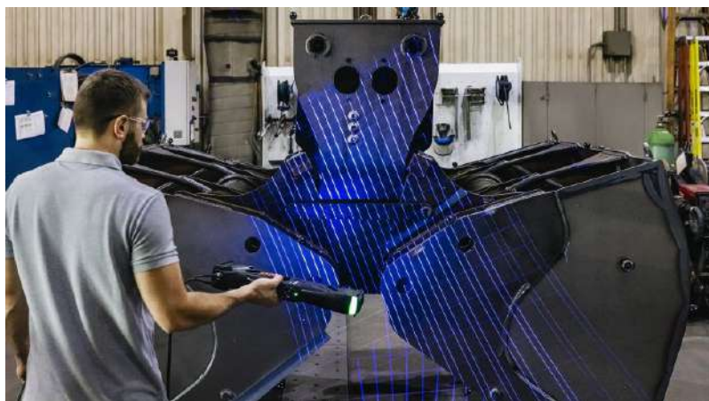
Рисунок 3.4 – Процес контролю 3Д сканером [6]
