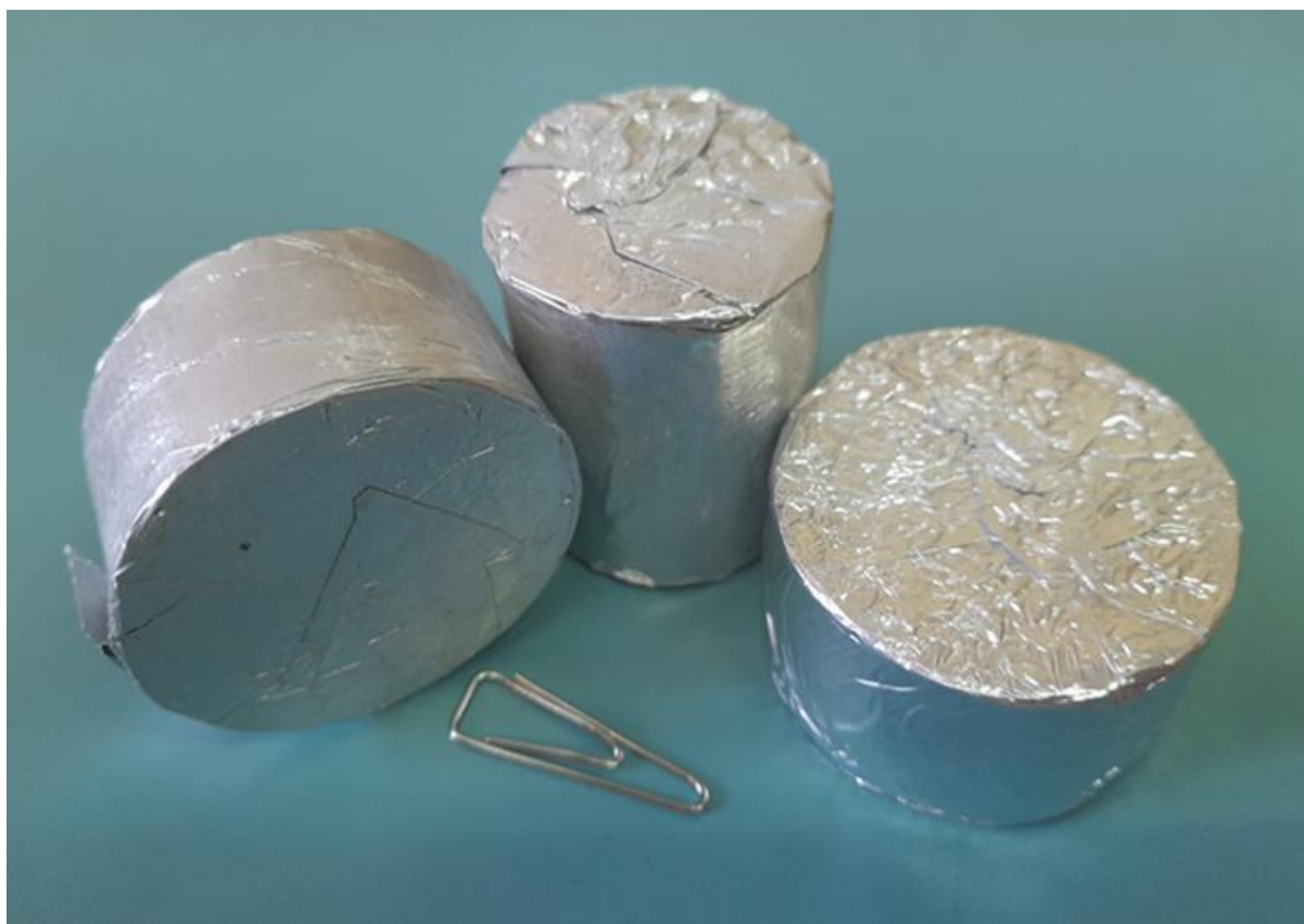
Рисунок 3.3 – Зовнішній вигляд таблетованого рафінувально-модифікувального комплексу
