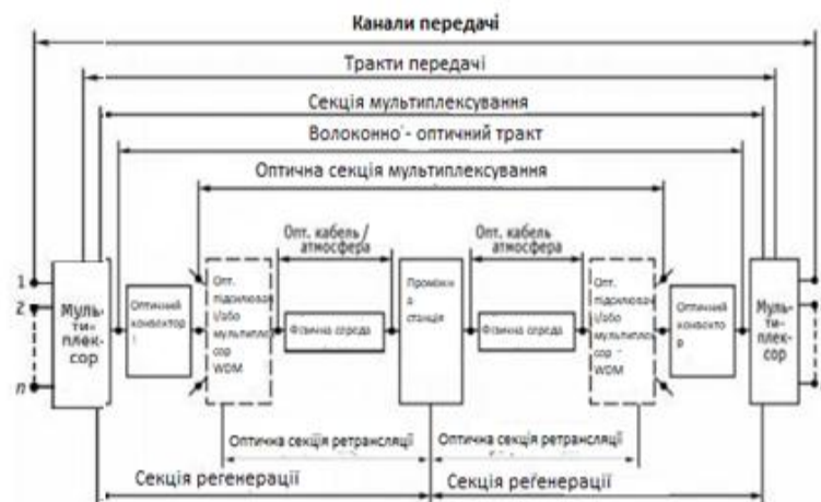
Рисунок 1.2 – Загальна схема оптичної системи передачі
