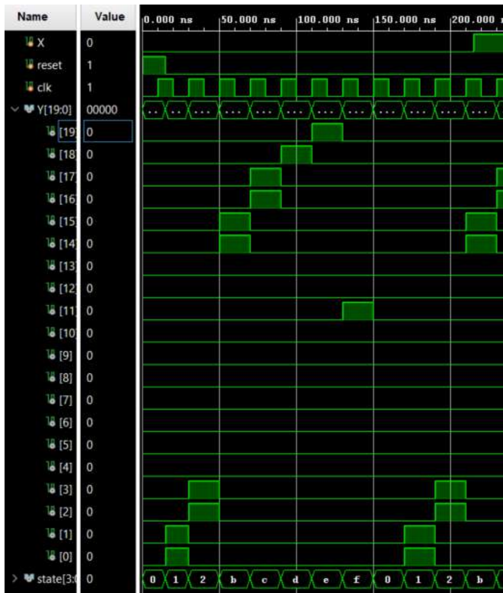
Рисунок 4.7 – Результати тестування керуючого автомата Мура для правої гілки алгоритму
