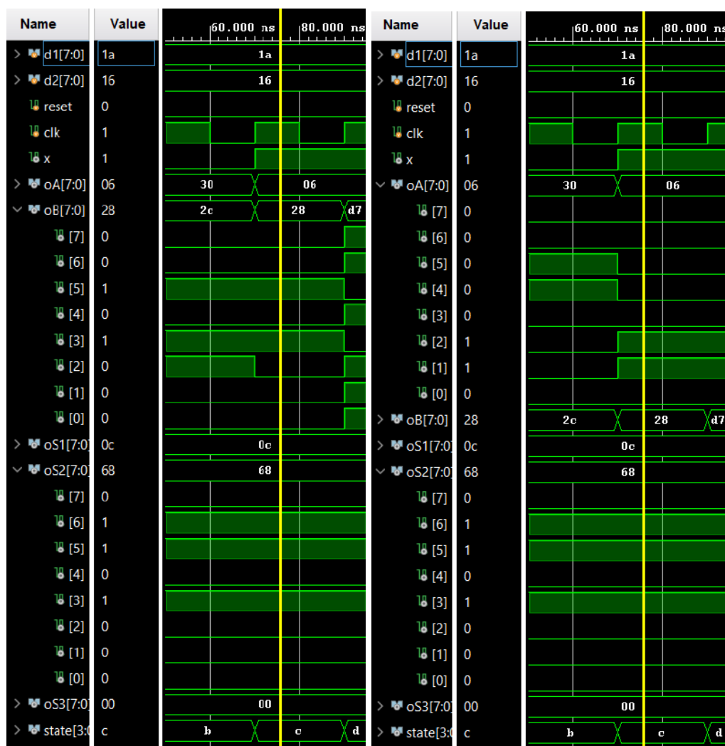
Рисунок 5.14 – Стан S12: виконання двомісної B = B and S2 та одномісної A = R3(A) операцій, де а) – вміст регістрів B, S2; б) – вміст регістрів A, S2
