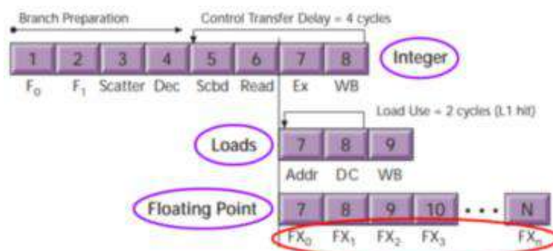
Рисунок 1.4 – Виконавчий конвеєр в процесорному ядрі E2K [6, с. 3]
