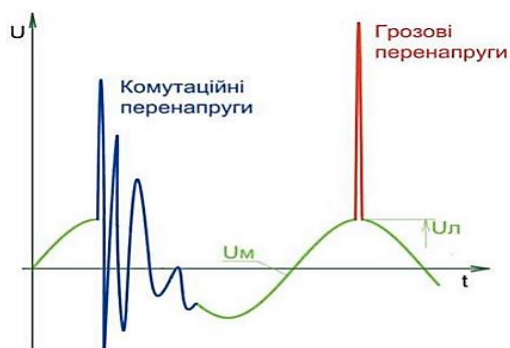
Рисунок 8.1 – Стилізований графік миттєвих значень напруги [47, 69]
