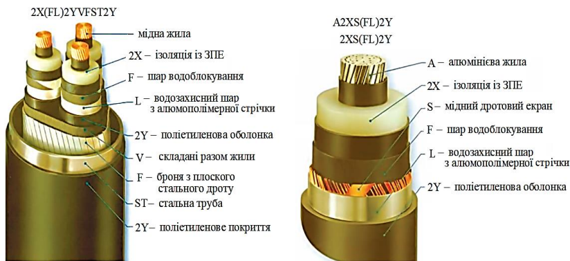
Рисунок 3.12 – Силлові ЗПЕ-кабелі марок 2X(FL)2YVFST2Y, A2XS(FL)2Y та 2XS(FL)2Y [100]
