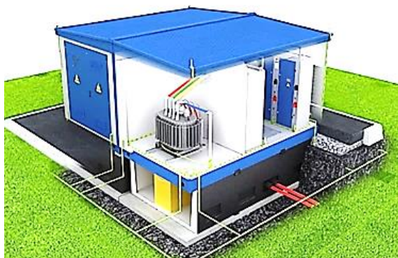
Рисунок 2.6 – Загальний вид комплектної трансформаторної підстанції в блочному виконанні модульного типу БКТП [45, 61, 84]
