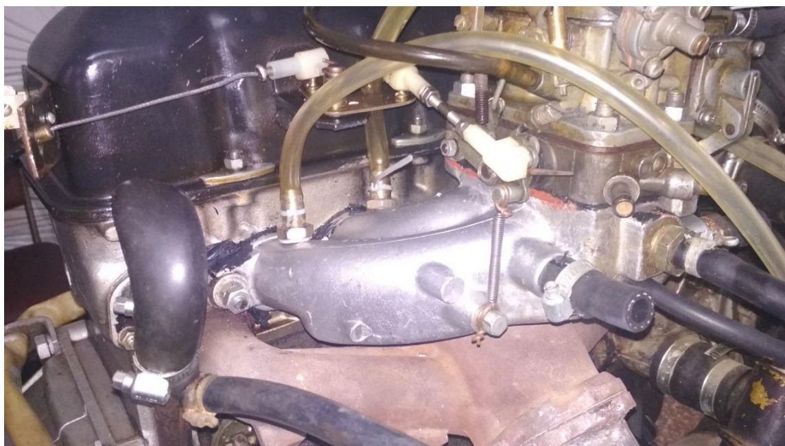
Рисунок 2.1.3 – Підведення вакуумних трубок до впускного колектору
