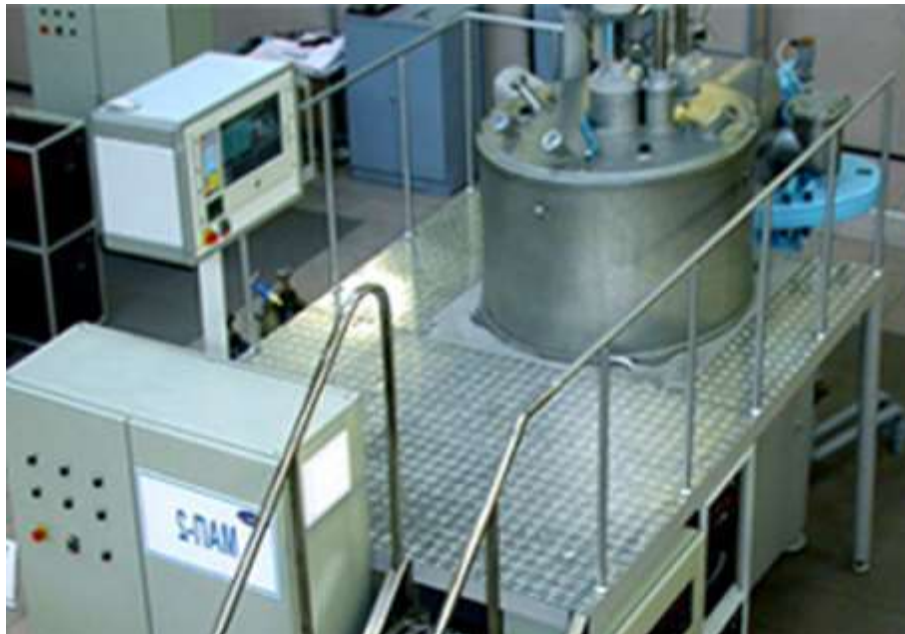
Рисунок 4.1 – Установка МАП-2 для нанесення іонно-плазмових багатокомпонентних захисних і зміцнюючих покриттів
