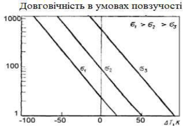
Рисунок 2.5 – Залежність довговічності лопатки турбіни від температури металу при різних рівнях напруги [5]
