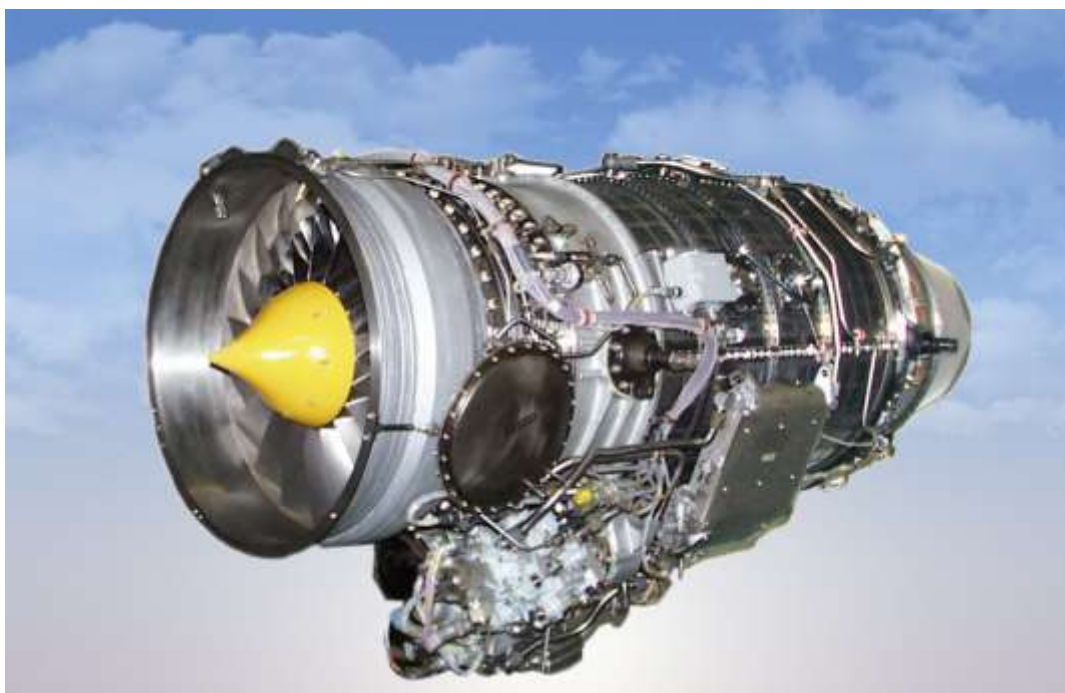
Рисунок 1.1 – Турбореактивний двоконтурний авіадвигун АІ-322 [2]
