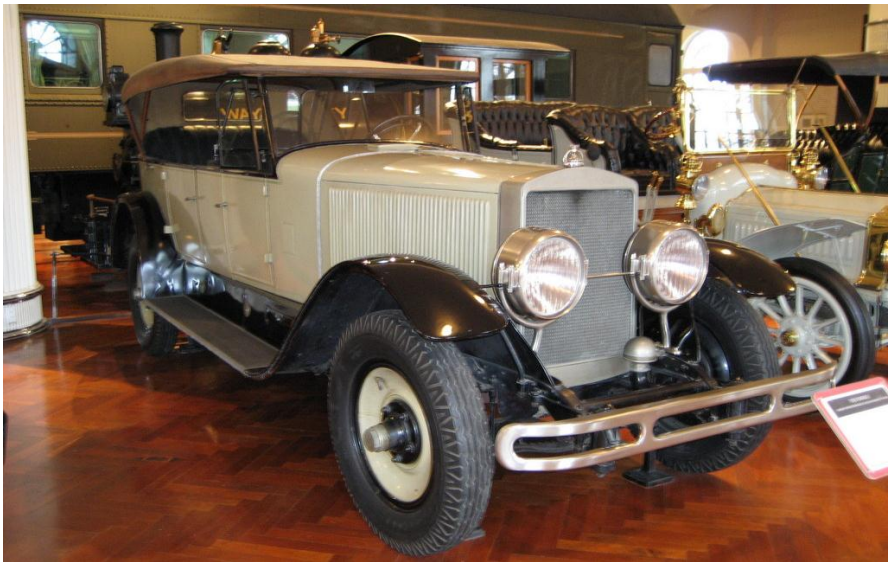
Рисунок 2.3 – Паровий легковий Doble Model E 1924 року
