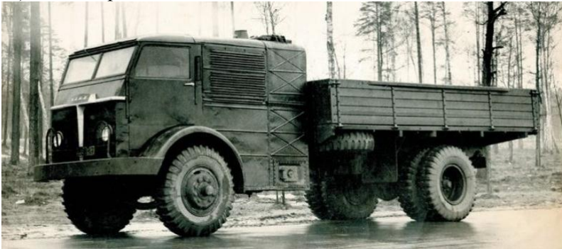
Рисунок 2.4 – Паровий НАМИ-012 на шасі семитонного ЯАЗ-200, 1948 рік
