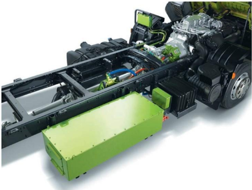
Рисунок 2.12 - Паралельна гібридна схема додатково додає 300 кг до ваги 12-тонної голландської вантажівки DAF
