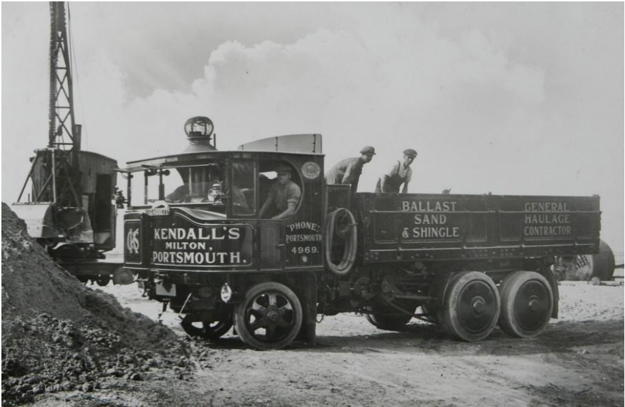
Рисунок 2.2 - Паровий вантажний 3-х вісний Garrett 1931 року (фірми "Richard Garrett & Sons")
