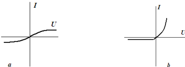
Рисунок 4.1 - Вольт-амперні характеристики а - симетричного б - несиметричного нелінійних елементів
