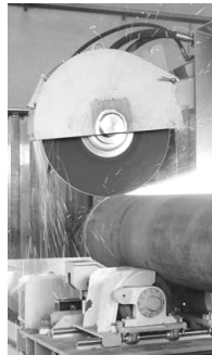
Рисунок 3.6 - Зовнішній вигляд інструмента - абразивного круга (а) та обладнання – абразивно-відрізного верстата (б)
