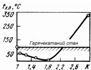
Рисунок 4.3 – Зміна порогу холодноламкості t_{кл}, ^\circ C термічно зміцненої сталі в залежності від ступеня зміцнення K ( K = \sigma_{В\text{ терм. зм.}} / \sigma_{В\text{ гар. кат.}} )
