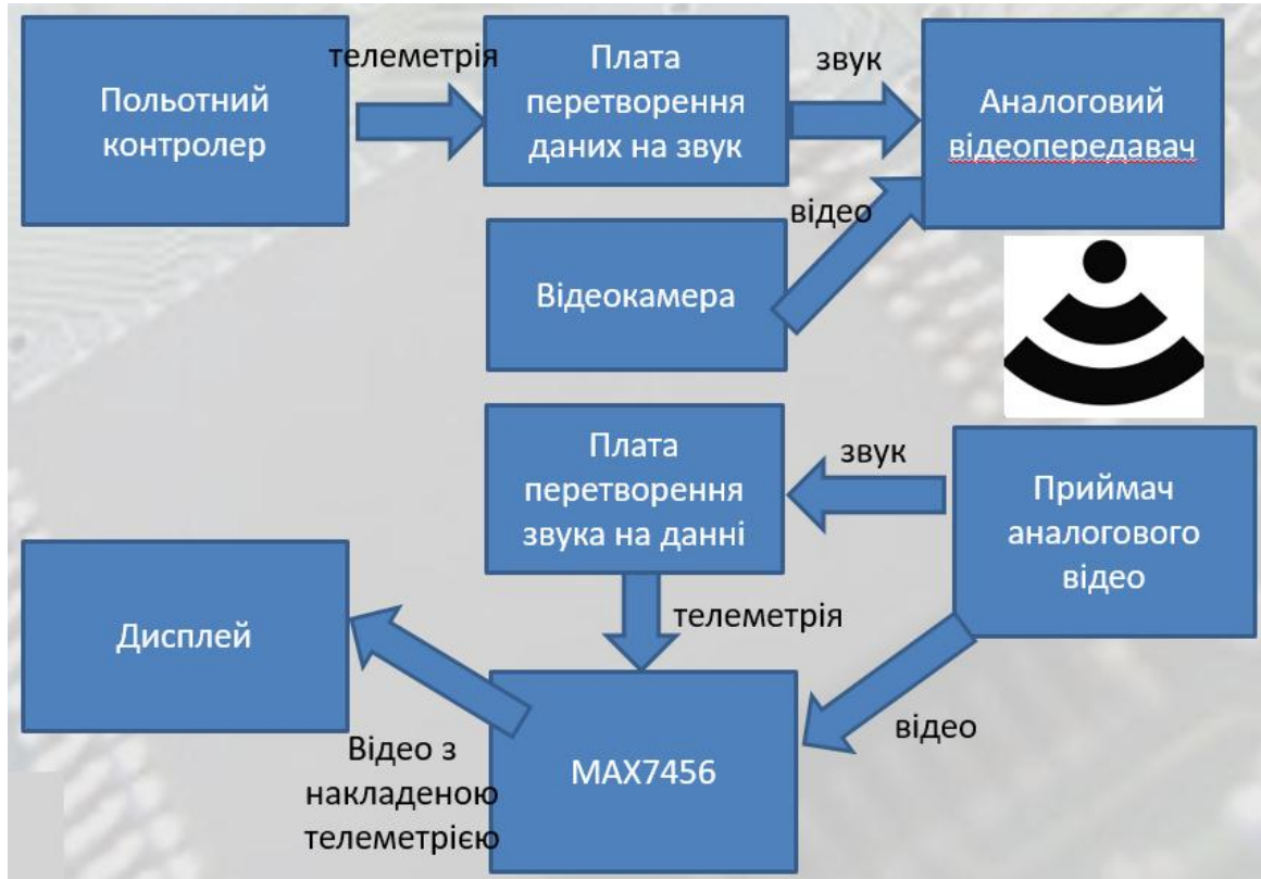
Рисунок 3.2 – Структурна схема схованої передачі телеметрії по аудіоканалу
