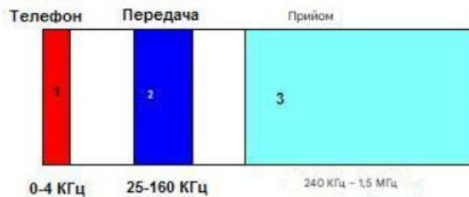
Рисунок 2.2 – Частотні діапазони роботи ADSL модему
