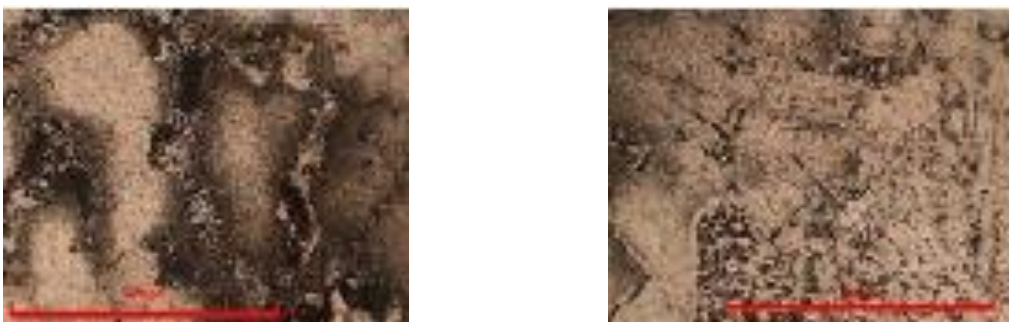
Рисунок 3.7 – Мікроструктура промислового сплаву ВЖЛ12Э без ТО, сформована в зоні зварювання дослідною присадкою ЖСЗЛС-М: \times 100
