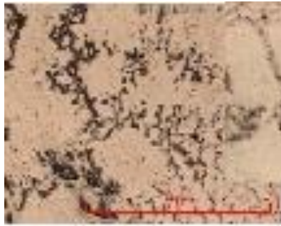
Рисунок 3.8 – Мікроструктура промислового сплаву ВЖЛ12Э без ТО, сформована в зоні зварювання серійною присадкою ЭП367
