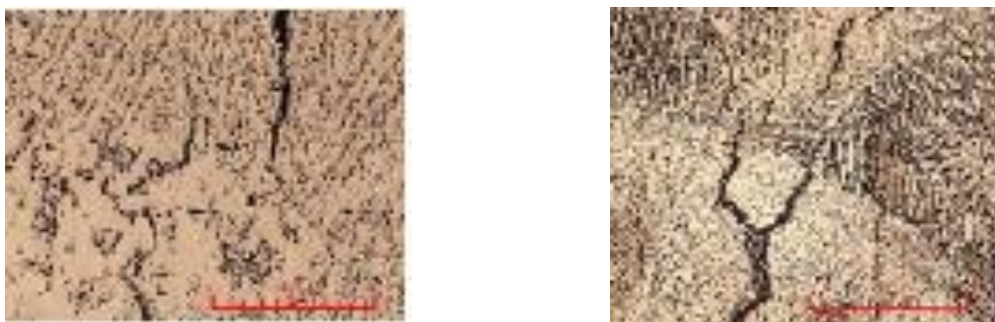
Рисунок 3.5 – Тріщини, що виходять на зовнішню поверхню по межі зварного шва і зони термічного впливу в зварних зразках-темплетах сплаву ВЖЛ12Э: \times 50
