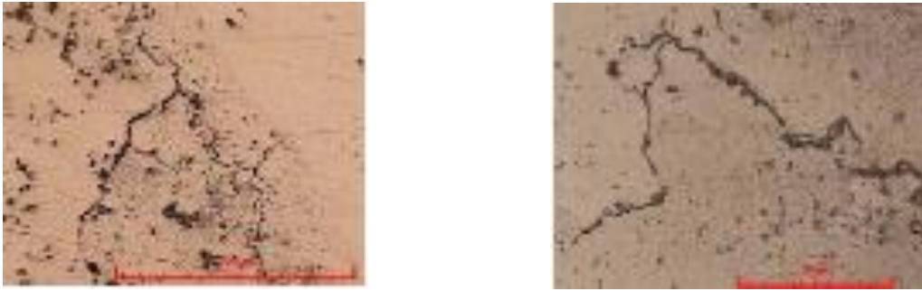
Рисунок 3.6 – Внутрішні тріщини по межах зерен у зварних зразках-темплетах сплаву ВЖЛ12Э
