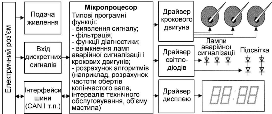
Рисунок 14.15 - Блок-схема функціонування комбінації приладів з використанням бортового контролера зв'язку CAN
