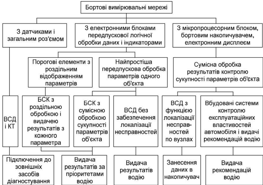
Рисунок 14.17 - Класифікація вбудованих засобів діагностування
