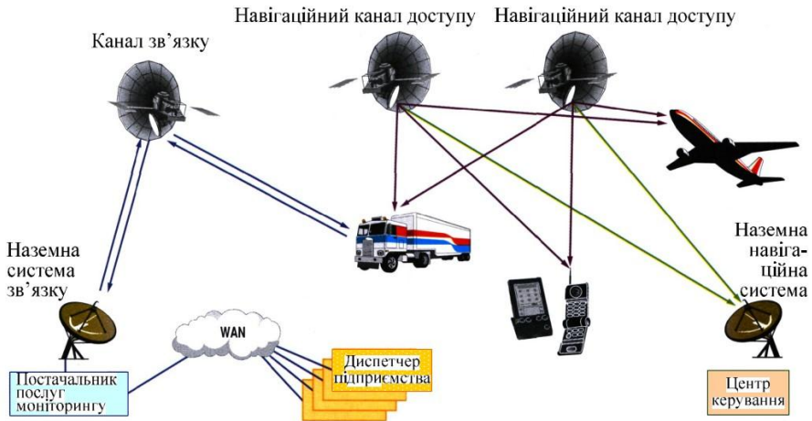
Рисунок 14.10 - Принцип дії супутникової навігації
