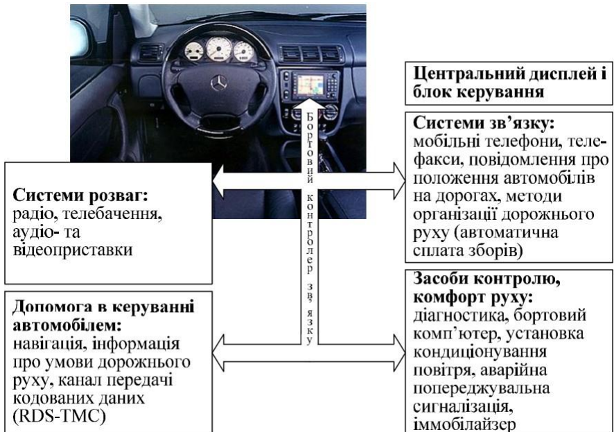
Рисунок 14.12 - Структура інформаційної системи транспортного засобу
