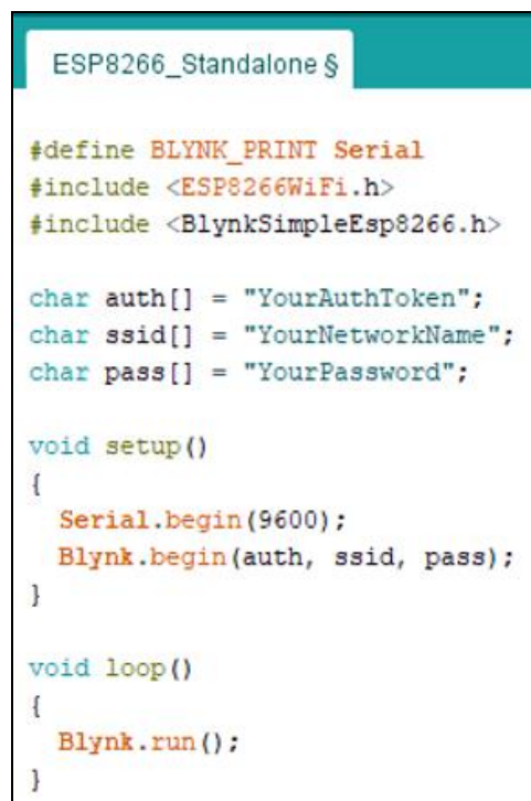
Рисунок 5.3 – Базовий код для зв'язку ESP8266 та Blynk
