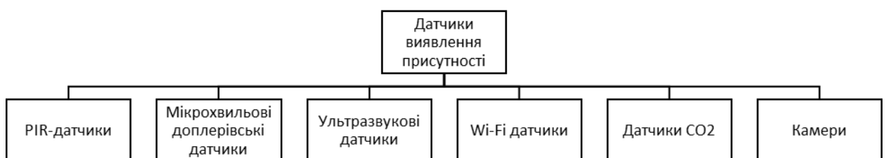
Рисунок 1.4 – Типи датчиків виявлення присутності
