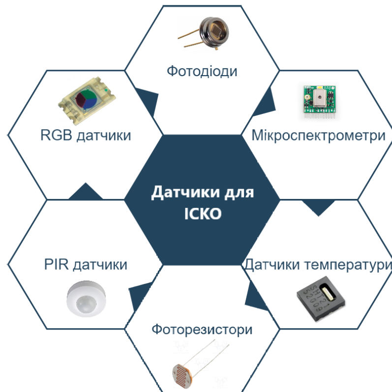
Рисунок 1.3 – Типи датчиків ІСКО [17]
