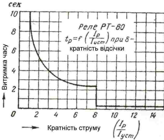
Рисунок 2.5 – Характеристика реле РТ-81
