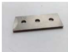
Рисунок 4.2 – Зразок для дослідження динамічних процесів при кінцевому фрезеруванні
