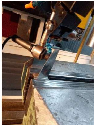
Рисунок 4.3 – Визначення ЧВК лопатки методом ударного збудження
