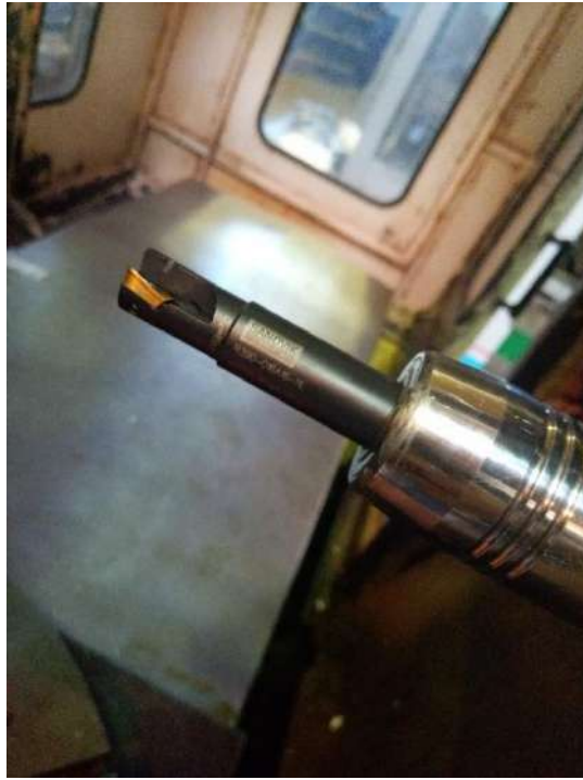
Рисунок 5.12 – Кінцева фреза з механічним кріпленням різальних пластин.
