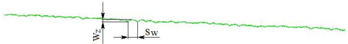
Рисунок 5.35 - Профілограма обробленої поверхні при попутному фрезеруванні з частотою варіювання швидкістю різання 3Гц та амплітудою 20%.
