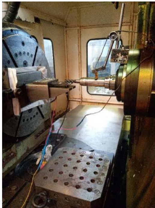
Рисунок 5.10 – Фрезерування зразка на верстаті МС 668 чотиризубою циліндричною фрезою
