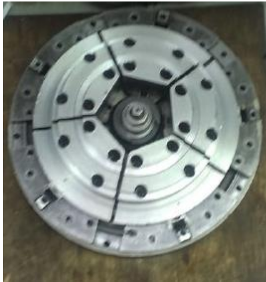
Рисунок 5.3 – Типовий приклад пристосування для деталей тіл обертання
