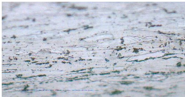
Рисунок 3.9 - Структура холоднокатаного (нагартowanego) прокату - нерекристалізоване зерно фериту, текстура ( \times 200 )
