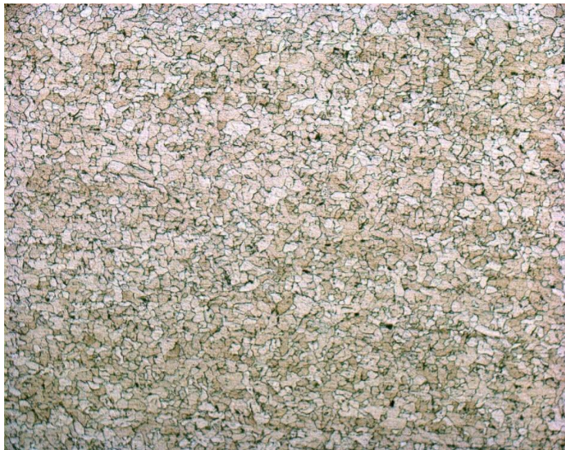
Рисунок 3.13 - Структура відпаленого прокату – рекристалізоване зерно фериту ( \times 200 )
