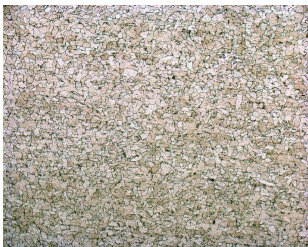
Рисунок 3.13 - Структура відпаленого прокату – рекристалізоване зерно фериту ( \times 200 )
