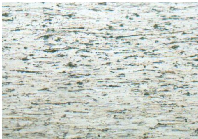
Рисунок 3.8 - Структура холоднокатаного (нагартowanego) прокату - нерекристалізоване зерно фериту, текстура ( \times 200 )
