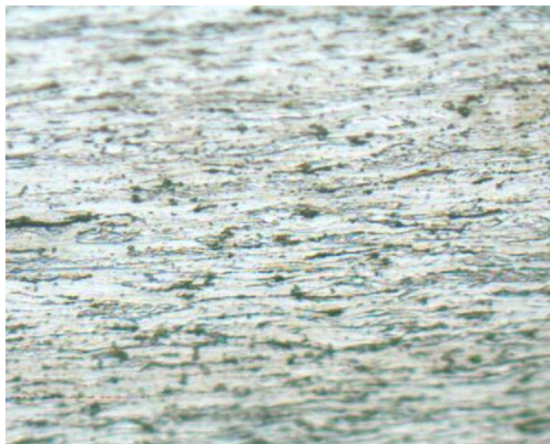
Рисунок 3.7 - Структура холоднокатаного (нагартowanego) прокату - нерекристалізоване зерно фериту, текстура ( \times 200 )
