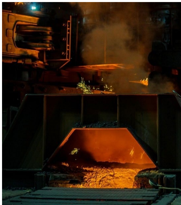
Рисунок 1.2 – Жолоб для руху рідкого чавуну ДП-3
