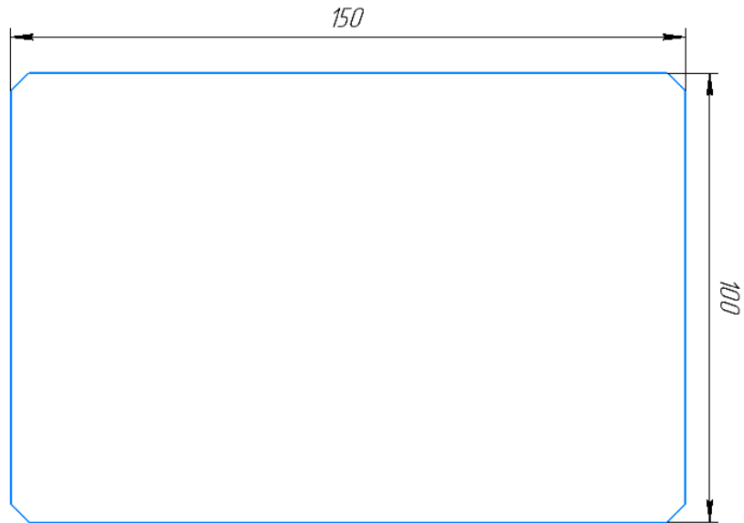
Рисунок 3.4 Креслення підкладки для вирощування
