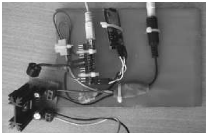
Рисунок 2.26 – Прототип підсистеми звукових повідомлень
