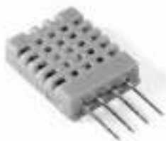
Рисунок 2.36 - Датчик температури та вологості DHT11
