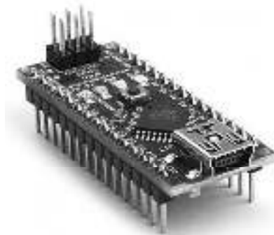
Рисунок 2.43 – Arduino Nano V3
