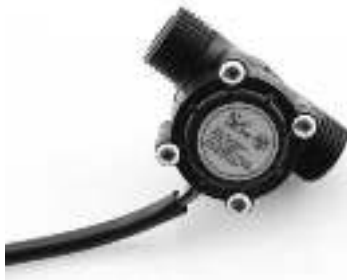
Рисунок 2.45 – Датчик потоку води
