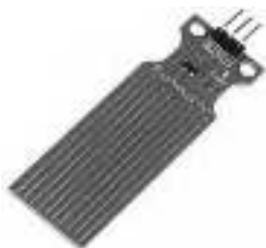
Рисунок 2.34 - Аналоговий датчик рівня рідини
