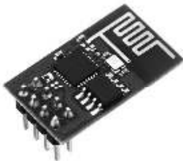
Рисунок 2.44 – WiFi модуль ESP8266-01
