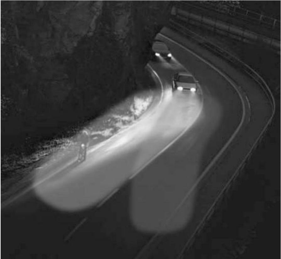
Рисунок 9.30 - Ситуація в якій ASF допомагає освітленню дороги
