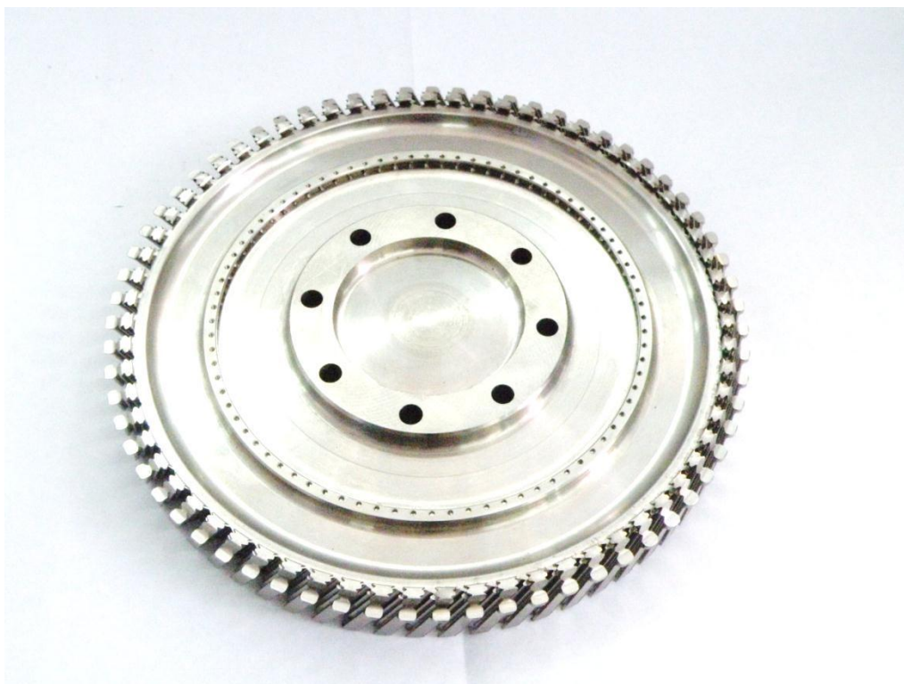
Рисунок 1.1 - Диск ГТД зі сплаву ЕП741НП виготовлений методом металургії гранул.
