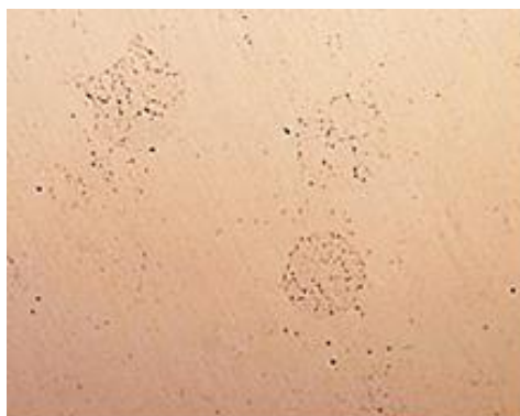
Рисунок 3.19 – Границі окремих гранул в структурі заготовок після ГП та термообробки
