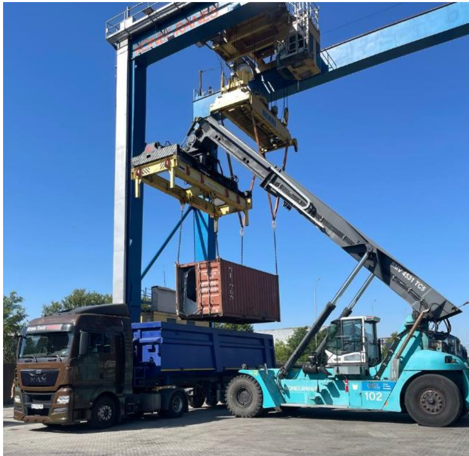
Рисунок 1.17 – Візуалізація процесу перевантаження нафтококсу із контейнера в напівпричіп-самоскид
