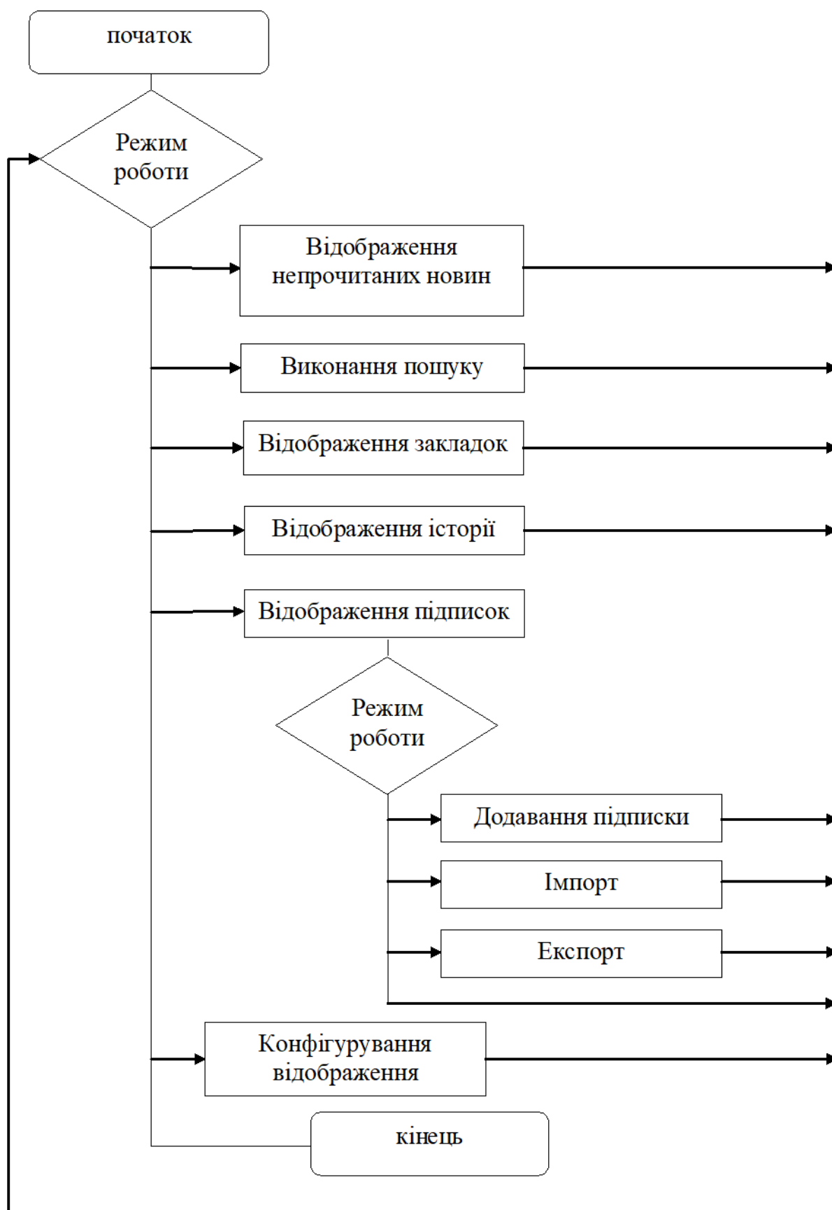
Рисунок 3.2 – Схема функціонування програмної системи для агрегації та оброблення новинних потоків
