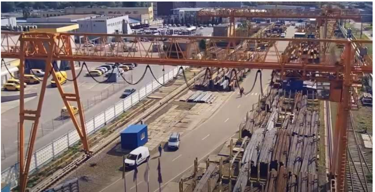
Рисунок 1.4 – Склад із розташуванням залізничної колії під консоллю козлового крану, а автомобільного під'їзду і зон зберігання металопрокату в прольоті крану
