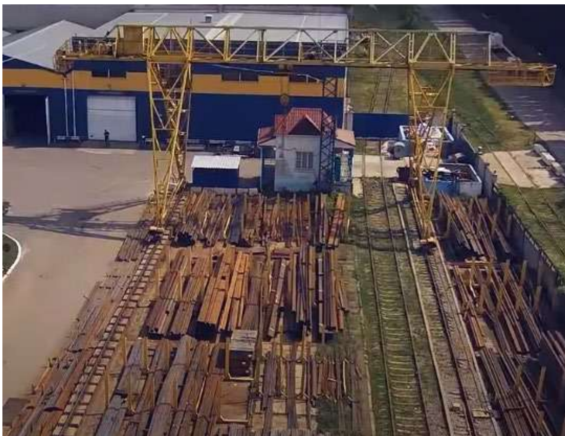
Рисунок 1.3 – Склад із розташуванням автомобільного під'їзду під консоллю козлового крану, а залізничної колії і зони зберігання металопрокату в прольоті крану
