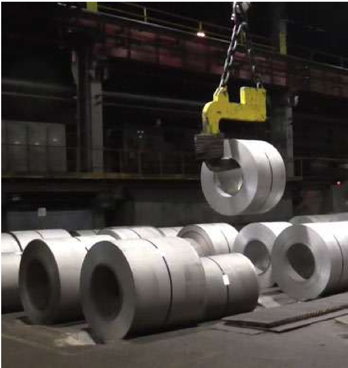
Рисунок 1.11 – Переміщення металопрокату ЦХП-1 скобою
