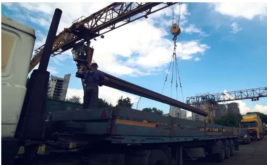
Рисунок 1.6 – Відвантаження металопродукції зі складу козловим краном на автотранспорт
