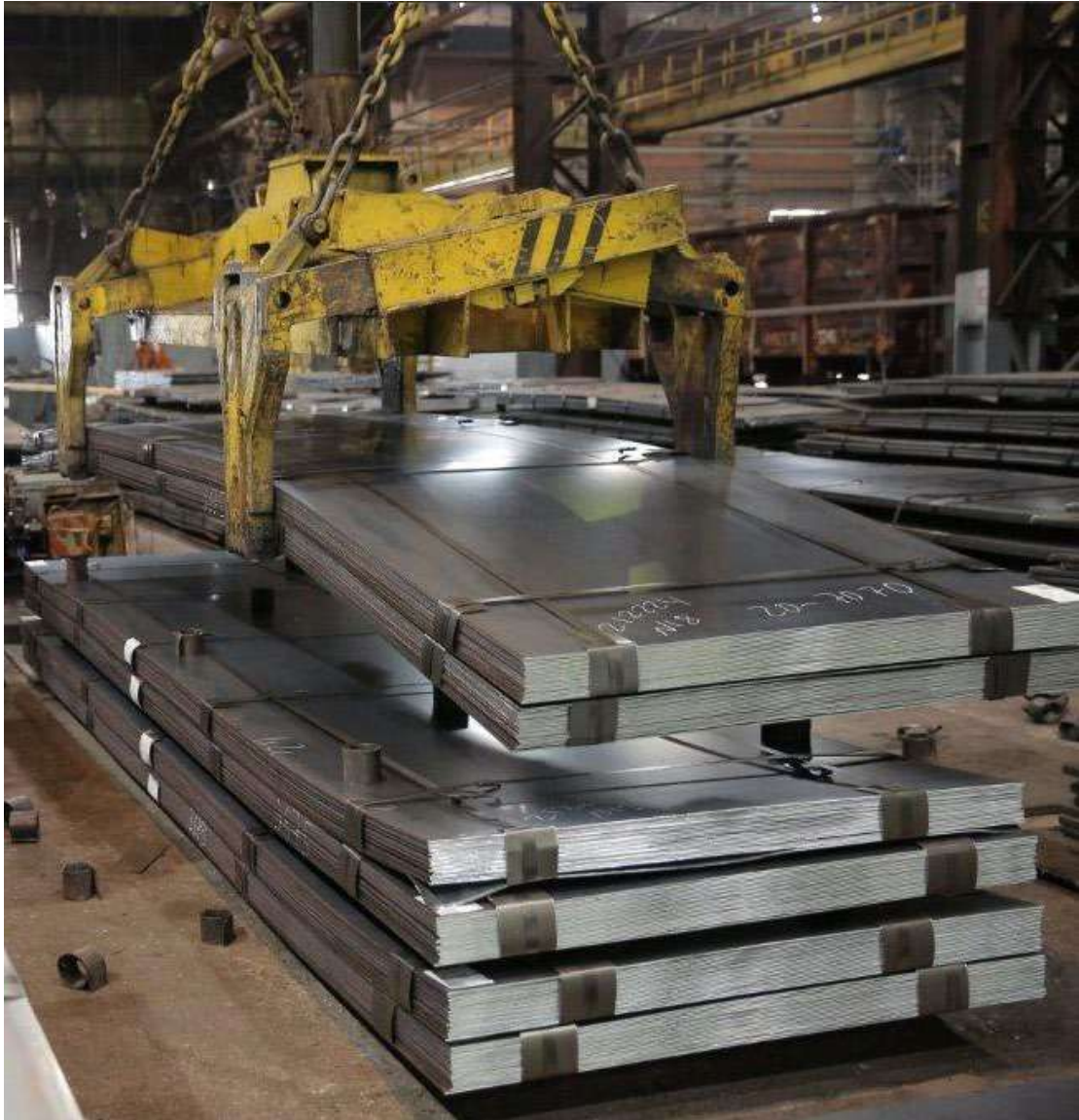
Рисунок 1.10 – Використання механічної траверси для переміщення пачок листового прокату в ЦГПТЛ
