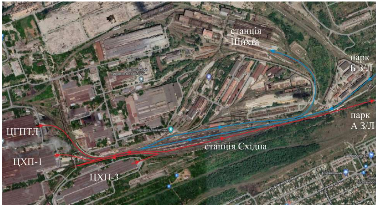
Рисунок 1.7 – Схема руху завантажених вагонів по об'єктах МЛСЗ
