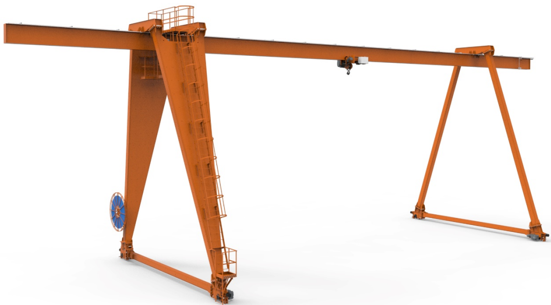
Рисунок 2.5 – Загальний вигляд обраного козлового крану
