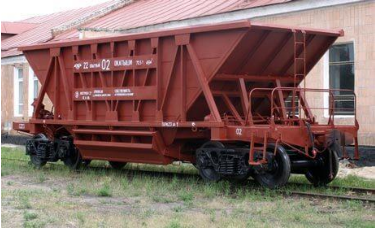
Рисунок 1.6 – Хопер для перевезення агломерату
