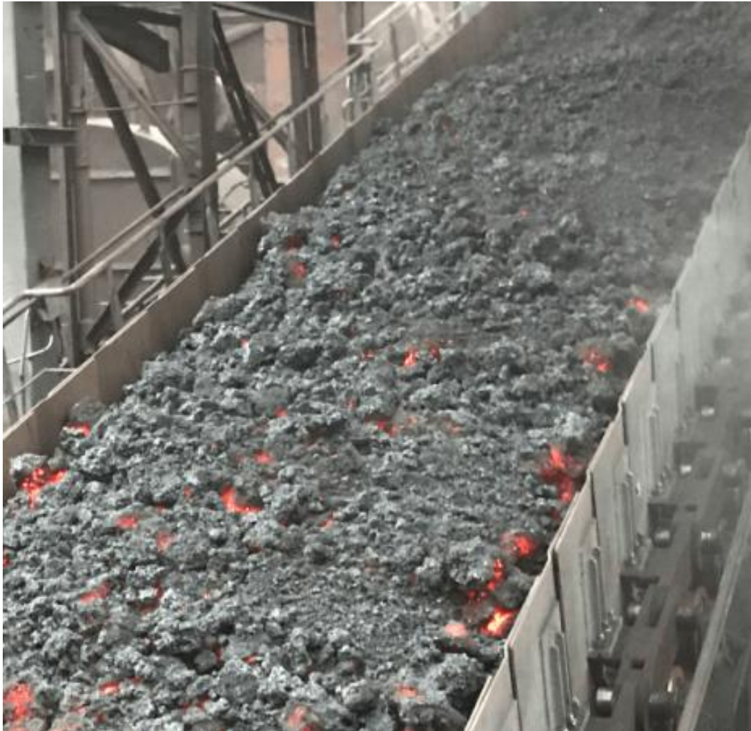
Рисунок 1.4 – Агломерат, який рухається по конвеєру агломашини до пункту навантаження
