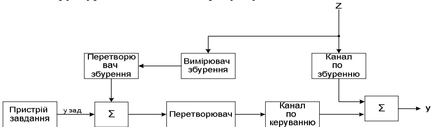
Рисунок 4.3 – Структурна схема САК з принципом керування за збуренням
