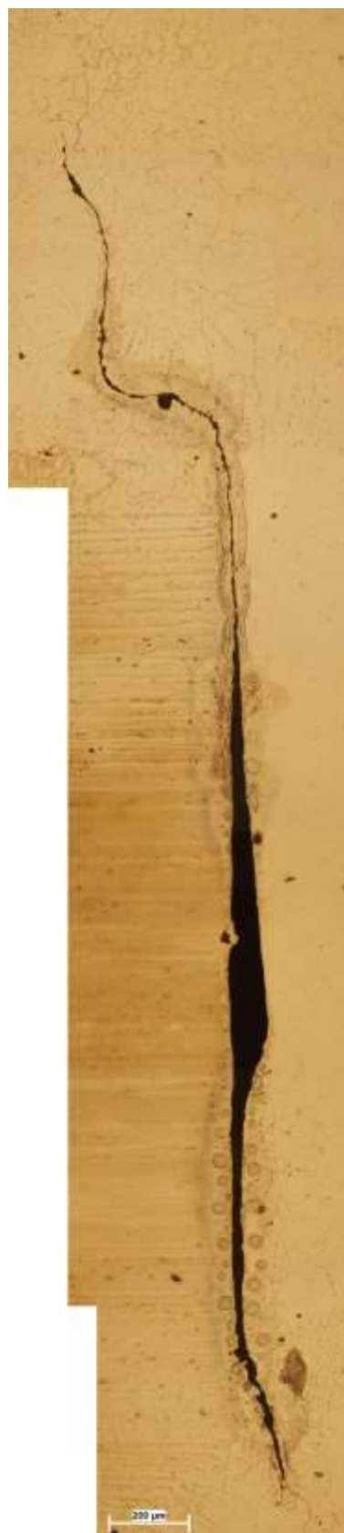
Рисунок 5.7 – Варіант №1 (Присадка Al-Mg). Панорама стику, x200
