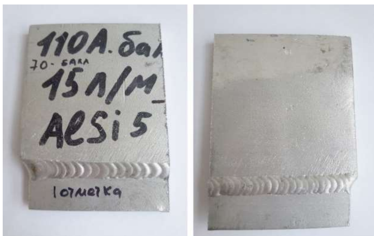
Рисунок 5.3 – Зварне з'єднання, яке виконано за варіантом №3
