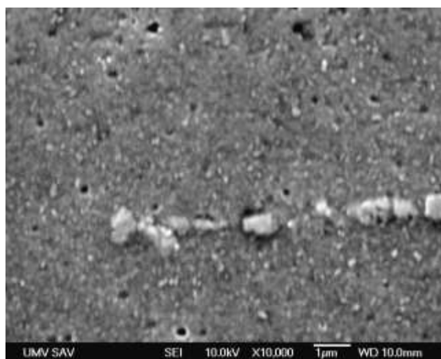
Рисунок 4.3 – Мікроструктура ремонтного сплаву, x10000
